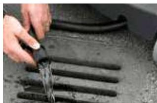
Sistema de descarga de líquidos para vaciar rápidamente el bidón de los líquidos aspirados
